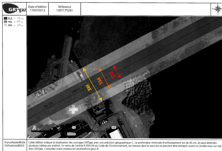
FIGURE 8 : LOCALISATION DES OUVRAGES GRT GAZ AVEC ZONES DE DANGERS SITUÉES DE PART ET D'AUTRE DE CES DERNIERS (SOURCE : GRTGAZ, 2013)
